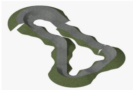
A pista é aberta nas laterais, com grama esmeralda em placas em todo seu entorno e na parte interna da pista. Possui camada de rolamento em concreto betuminoso usinado quente
